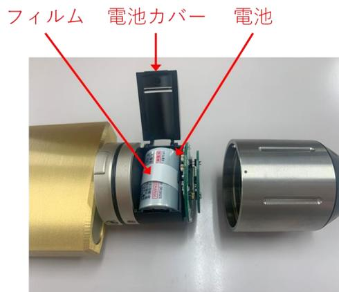
電池カバーを開けると電池が露出します。
