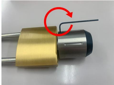
反対側も同様に、六角レンチを差し込み回らなくなるまで押し込みながら時計回りに回します。
