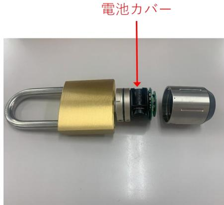
カバーを外すと電池カバーが露出します。
