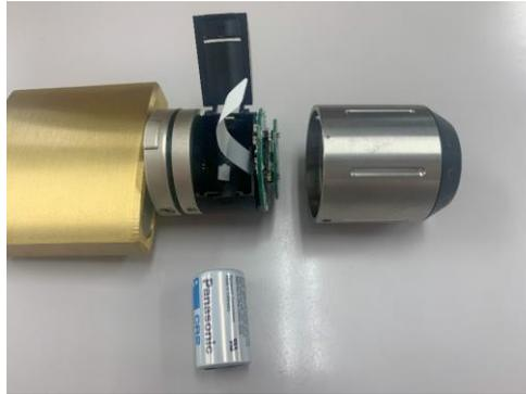
電池を抜き取り、新しい電池を用意します。
