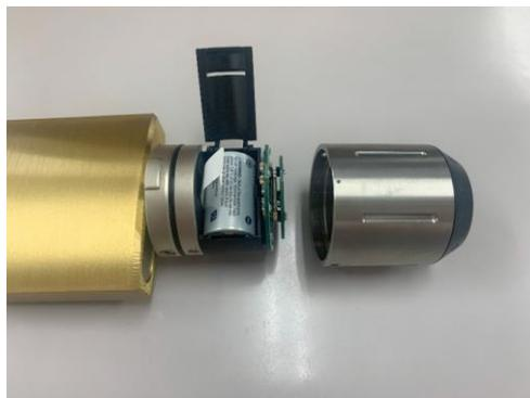
電池を装着したら、フィルムの端をかぶせて電池カバーを閉じます。
