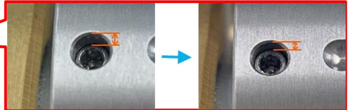
側面の穴に六角レンチを差し込み、反時計回りに回します。
