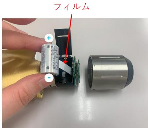
フィルムの上から電池を装着します。電池の方向に注意してください。
